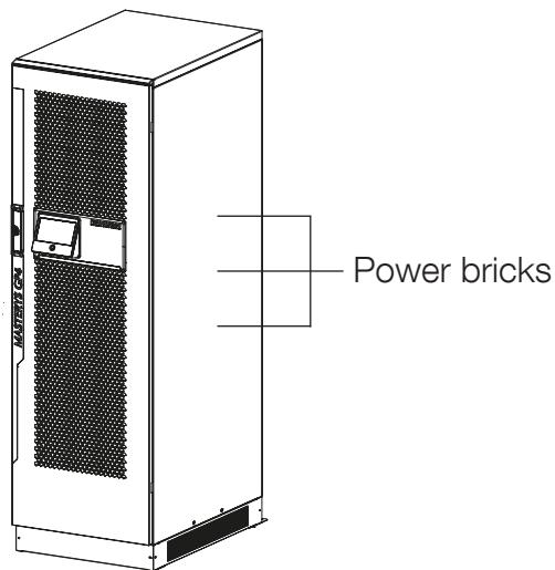
Tout défaut potentiel doit être isolé à l'intérieur des sous-ensembles concernés, en gardant la charge critique protégée en mode double conversion grâce aux convertisseurs de puissance restants afin de maximiser le Temps Moyen entre Pannes Critiques (Mean Time Between Critical Failure).
