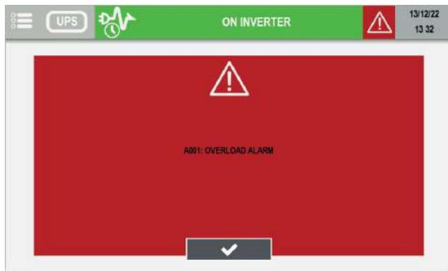
Cliquer sur le bouton de validation pour arrêter le buzzer et fermer la fenêtre de message. La page des alarmes apparaît ensuite automatiquement.
