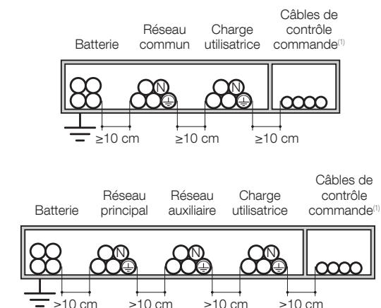
(1) Câbles de contrôle commande : raccordements entre les armoires et chaque unité, signaux d'alarme, synoptique distant, connexion au système BMS (Building Management System), arrêt d'urgence, raccordement au groupe électrogène.
