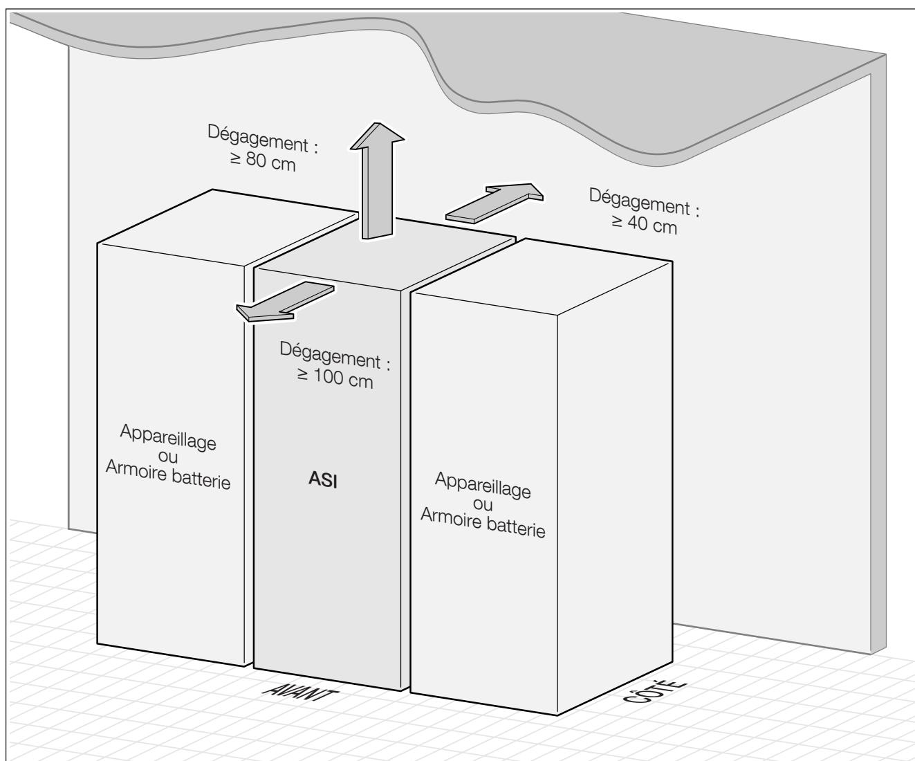
(1) Dégagements recommandés dans les conditions les plus défavorables (à charge nominale et température ambiante de 40 °C). Contacter SOCOMEC pour des conditions d'installation et applications différentes.
