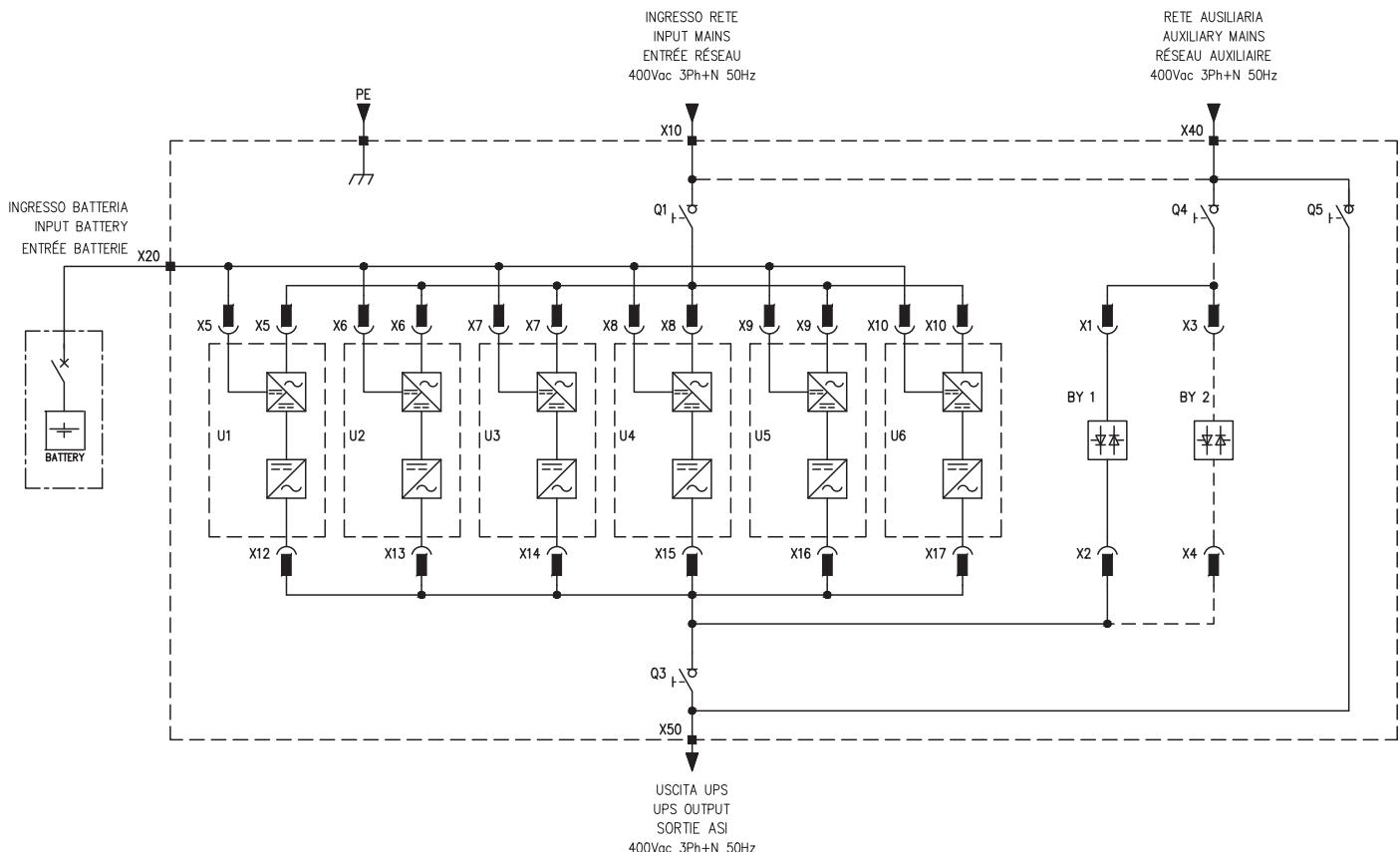
**Système avec interrupteurs pour le by-pass manuel, l'entrée réseau principal, le réseau auxiliaire, la sortie utilisations et backfeed interne (avec ou sans module by-pass supplémentaire).**
